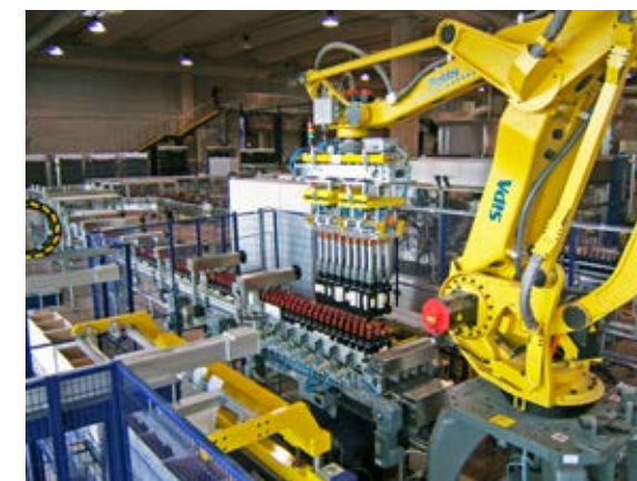
Soluzione combinata di incartonnamento per bottiglie orizzontali e verticali con dispositivo di inserimento di interfalde. Testa di presa multipla (teste di presa a membrana pneumatica e ventose) e ribaltatore bottiglie per l'incartonnamento di bottiglie capovolte.
