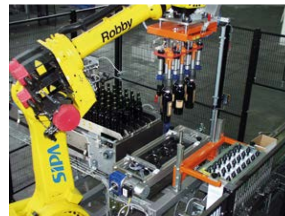
Testata di presa mista (tese di presa a membrana pneumatica e ventose) e ribaltatore per l'inserimento di bottiglie capovolte
