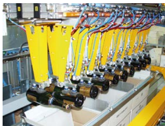
Testata con pinza a ventose per l'incartonnamento di bottiglie orizzontali e incrociate
