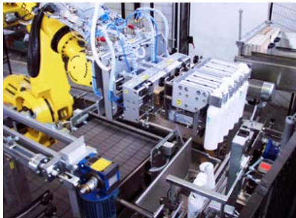
Cabezal de agarre versátil con garra y ventosas para el encajado horizontal de botellas envueltas en papel, que gestiona tanto los productos como los separadores de cartón
