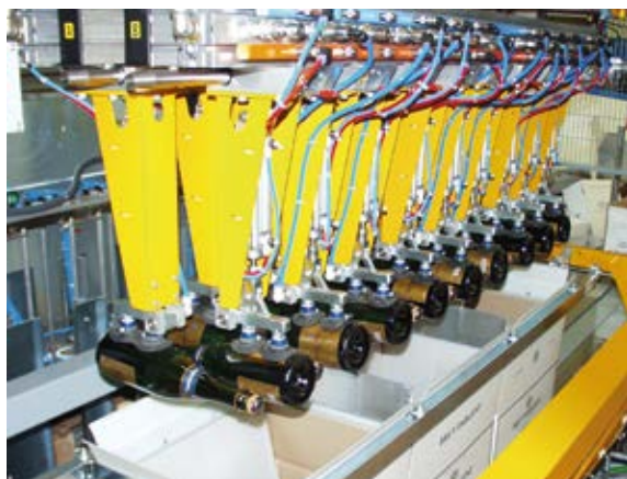
Cabezal de agarre por ventosas para el encajonado de botellas horizontales y cruzadas
