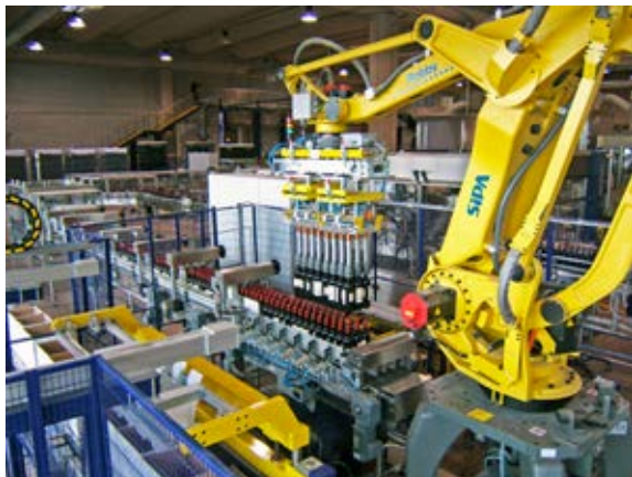
Solución combinada de encajado para botellas horizontales y verticales con dispositivo de inserción de interláminas. Cabezal de agarre múltiple (cabezales de agarre de membrana neumática y ventosas) y volteador para la inserción de botellas invertidas
