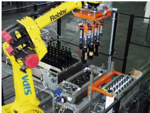
Cabezal de agarre mixto (pequeños cabezales de agarre por membrana neumática y ventosas) y volteador para la inserción de botellas invertidas
